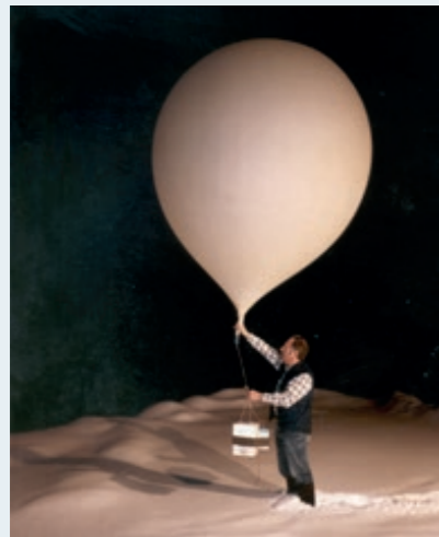
Opsendelse af ozonsonde til profilmåling af atmosfæren.
